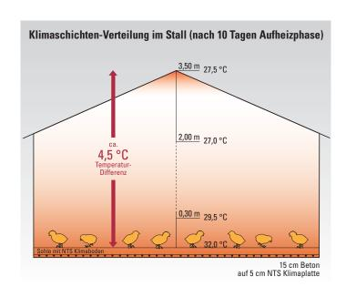
einem direkten Umsatz-Wachstum von ungefähr 5%. Wir erklären uns die unterschiedlichen Aufzuchtergebnisse dadurch, dass die Küken während der Wachstumsphase ca. 40% ihrer Energie an den Boden abgeben. Bei NTS Klimaböden ist dies nicht der Fall. Aufgrund der gleichmäßigen Bodenwärme wird der Stoffwechsel entlastet und macht Ressourcen für zusätzliches Wachstum frei.
